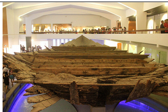
泉州海外交通史博物館に陳列された宋代の古船。これは遠洋貿易船である。浸水防止のために安全装置として水密隔壁によって仕切られた防水隔室がはっきり見える。
